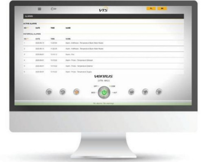
Gestion des défauts et alarmes :
